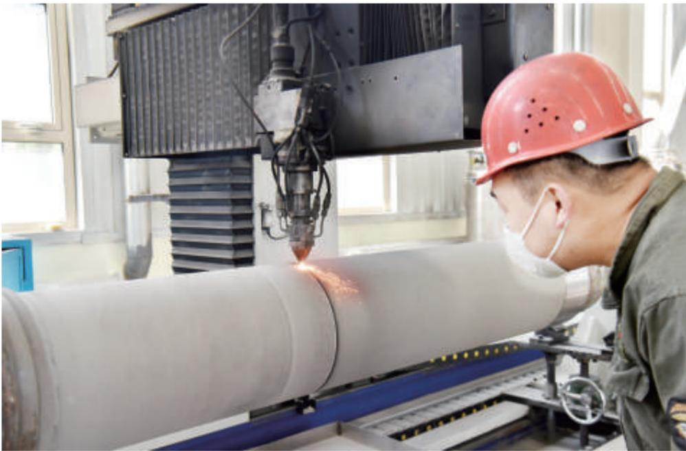
朔州金华实业有限公司是位于市经济技术开发区的一家集机械铸造、煤机智能化改造、重型装备再制造与技术服务为一体的高新技术企业，2021年在我市运营以来，凭借独特的技术在国内外同行业取得了不错的口碑，激光熔覆技术在蒙古国得到了认可，为公司取得了首笔外贸订单。图为技术人员在对综采液柱柱进行熔覆技术修补作业。 薛礼伟 摄
