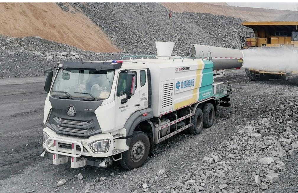
针对近期高温酷暑天气,安太堡露天矿通过加强日常洒水降尘频次,制定扬尘控制措施,扎实做好矿坑安全环保工作。图为该矿抑尘车正在矿坑道路进行抑尘作业。王汉平 摄
