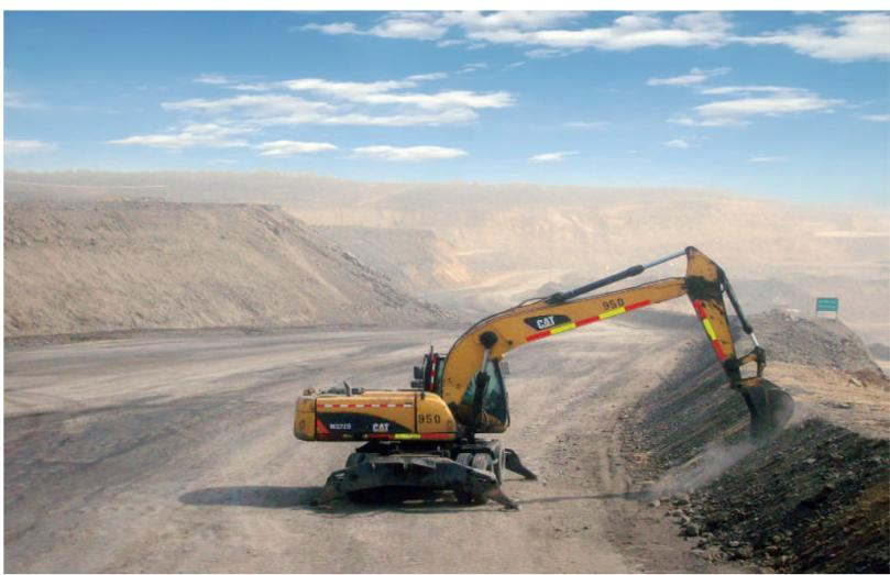
针对近期多发的强降雨天气,中煤平朔集团有限公司安太堡露天矿生产一队闻“汛”而动,全面排查各类安全隐患,并对查出的隐患落实到班组和责任人,督促限期整改,进一步筑牢雨季“三防”安全堤,为实施汛期安全生产提供了有力保障。因为该队反铲司机正在修筑夯实安全挡墙。
