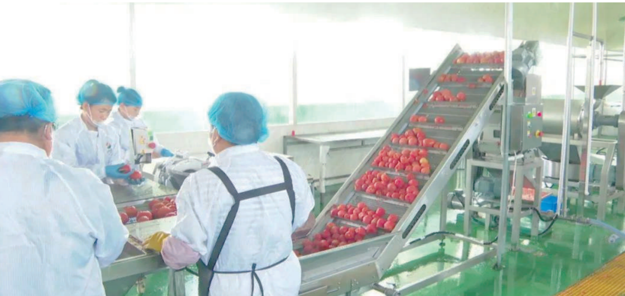
走进应县下社镇李堡村西红柿深加工车间,成筐的西红柿经过清洗等9道工序,从原果成为可供长期保存的优质西红柿罐头产品,像这样的一条生产线一天可以消化西红柿3吨。
