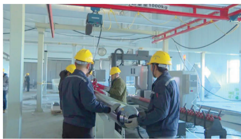
图为工作人员对刚刚下线的单晶硅棒进行切割。
