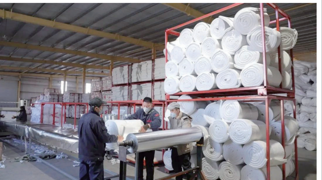
作为煤的伴生物煤矸石,它的热值低,利用率差,很长一段时间被人们称为固体废物。然而,在山阴县的赢胜(山西)陶瓷纤维有限公司,煤矸石却摇身一变,不仅变成了高岭土,还被制成了精美的陶瓷纤维产品。图为该公司的陶瓷纤维产品生产车间一角。 张晓宇 赵媛 摄
