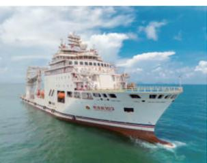
1月30日从交通运输部救助打捞局获悉,作为中国海上专业救援力量的新旗舰,交通运输部南海救助局满载排水量19000吨的“南海救103”轮当日正式投入使用。“南海救103”轮是由我国自行设计建造的深远海大功率多功能综合救助船,总长136.9米,型宽26.7米,型深11米,设计吃水6.5米。 新华社北京电 记者 叶昊鸣 摄
