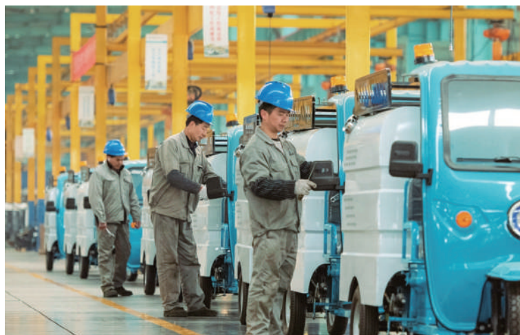
2月17日，在安徽省芜湖市繁昌经济开发区奇瑞新能源专用汽车生产车间里，工人组装新能源电动清扫车。
