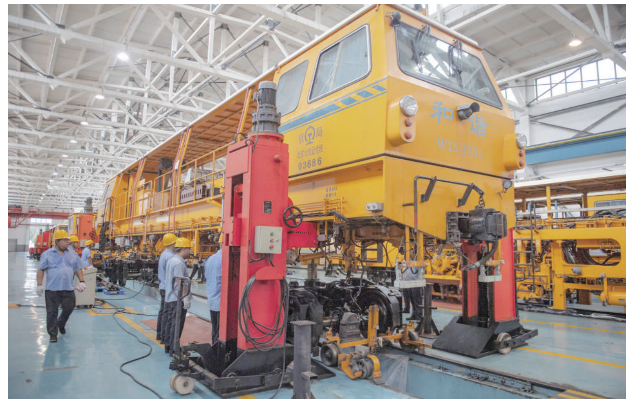
7月25日, 在国铁北京局北京大型养路机械运用检修段的检修库, 职工们进行架车作业。铁路暑运期间, 北京大机运检段的干部职工们需要完成56台大型机械车辆的检修试验任务, 全面排除设备故障隐患, 调试设备作业性能。待到暑运结束, 这些“大黄蜂”将奔赴京津冀区域各大铁路干线, 对线路实施拉网式检查整修。
