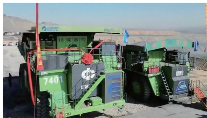
这台200吨级纯电动矿用自卸车于2024年10月完成设备组装与调试,正式进入工业运行试验阶段。整车采用安全性能好、性价比高的磷酸铁锂电池以及先进的电池管理系统,集纯电动、交流化、智能化于一体,且全部实现国产化。这台车正式投入使用后,每年可减少矿区二氧化碳排放1800吨,为露天煤矿行业实现“双碳”目标提供有力保障。
