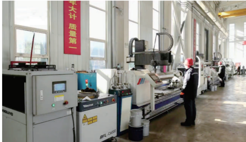
区运回车间，现在正在对液支架立柱千斤顶进行激光熔覆。根据目前的任务量，及时调整了工作计划，工人从以前的长白班换成了现在的三班倒，
