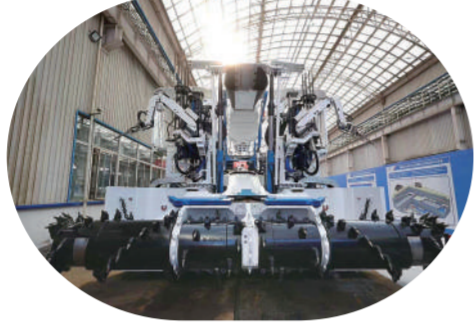
掘锚一体机正式投入使用
